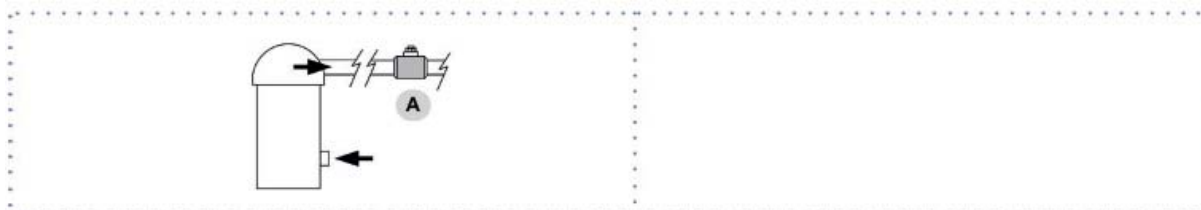
A. Hetgasledningens avstängningsventil
