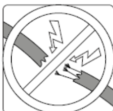
Se efter så inga ledningar är skadad
